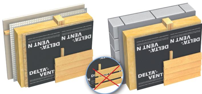
Mur avec isolation entre montants et panneau de contreventement extérieur :
