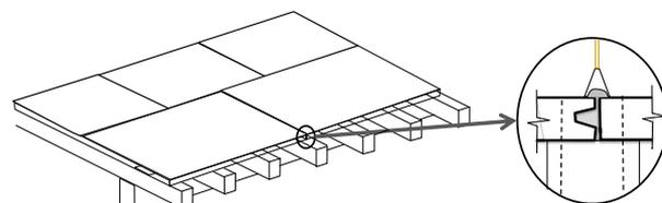
3. Poser la dalle suivante en ménageant un jeu de 2 mm puis mastiquer le vide
