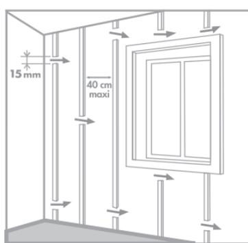
Fixer sur le mur des tasseaux (15 x 40 mm) avec 40 cm d'écart maximum. Ne pas oublier d'encadrer portes et fenêtres.
