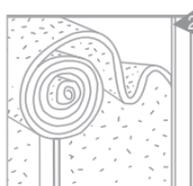
Pour isoler ou assainir vos murs, poser de la laine de verre ou un autre matériau entre les tasseaux. Prévoir des tasseaux d'une épaisseur supérieure à la laine de verre (15 mm de plus).
