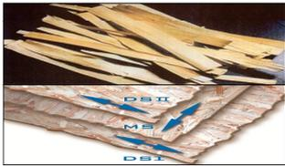
L'OSB est un panneau de bois aggloméré, composé de longues et fines lamelles de bois disposées et orientées en couches perpendiculaires superposées.
