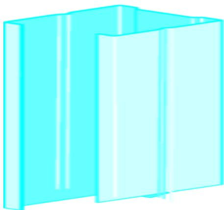
Profilé en acier galvanisé pour la réalisation de cloisons en plaques de plâtre sur ossature
