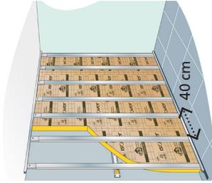
Poser un joint mousse ou résilient sous la lisse basse Clip'Optima **1**.
