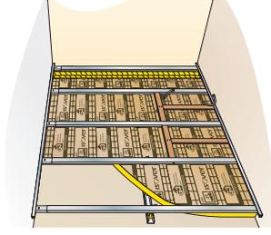
Après embrochage de l'isolant, placer les fourrures verticales pour constituer un plan de pose de même niveau entre les fourrures et l'ossature bois. Gruger ou découper leurs ailes aux points de rencontre avec l'ossature bois 2.
