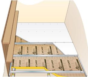
Poser une fourrure murale à 1,35 m du sol et une seconde entre les solives à environ 5 cm de la sous-face du plancher. Placer les appuis sur la fourrure murale tous les 60 cm 1.
