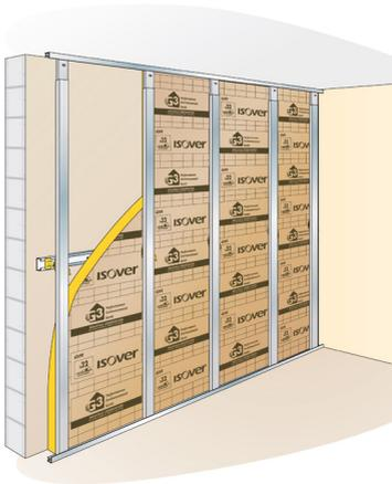
La fourrure verticale Optima constitue le plan de pose rigide du parement plaque de plâtre. Une plaque de plâtre de 1,20 m de large se fixe sur 3 fourrures.
