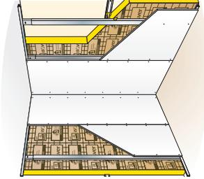
Embrocher l'isolant GR 32 sur les appuis Optima 2 et poser les clés **2**.
