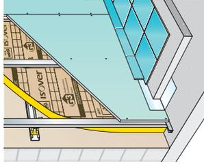
Laisser un espace d'environ 8 mm avec le sol pour jointoiment au mastic souple **7** avant la pose d'une plinthe (la plaque de plâtre ne doit pas toucher le sol).
