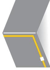
**Avec Optima, il est possible de rénover le circuit électrique**, de le mettre aux normes, actuelles ou de déplacer ou encore de créer des prises. Le vide technique constitué par l'épaisseur des fourreaux permet d'y faire passer les gaines. En cas de déplacement d'un point électrique (de 50 cm et plus), il est conseillé de placer un boîtier de dérivation. Cela permet la rallonge jusqu'à la nouvelle prise créée.
