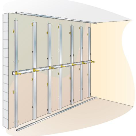
Fixation de la fourrure horizontale sur les fourrures verticales avec des vis Parker.
