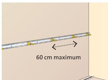
Les tiges doivent être fixées tous les 60 cm, conformément à l'Avis Technique du CSTB Optima 9/11 - 946. Cela correspond aux 1/2 largeurs courantes des plaques de plâtre (1,20 m).
