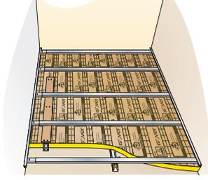
Poser le parement en plaque de plâtre. Après les finitions et revêtement, fixer les éléments de cuisine 5.
