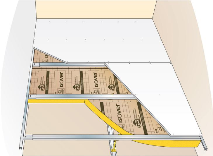
Tracer au sol et au plafond la limite de doublage. Visser les lisses Clip'Optima basses et hautes et poser la fourrure horizontale à 1,35 m du sol.
