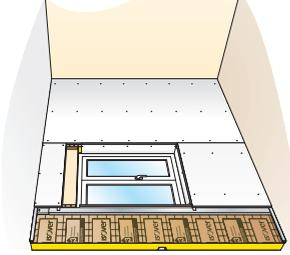
Poser ensuite l'habillage des tableaux latéraux et de l'appui, sauf en sous face de linteau sous le coffre. Poser 2 tasseaux latéraux pour fixer le futur capot d'accès au volet. Réaliser un capot léger, lui adjoindre un isolant type Multimax et le visser sur les tasseaux 5.
