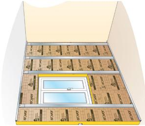
Pour réaliser l'ossature 1 fixer des segments de lisses en entourage du dormant 2.
