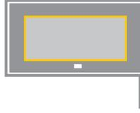
Pour l'entourage de porte, il faut réaliser un encadrement du dormant avec la lisse Clip'Optima. Deux fourrures verticales forment l'arête du doublage. Elles sont calées dans les lisses basses et hautes. Deux Connector Optima et une fourrure horizontale achèvent l'ossature.
