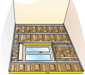
Visser le parement en allège sous l'appui de fenêtre puis au-dessus du coffre de volet roulant. Prendre appui sur 2 segments de fourrures posés parallèlement aux fourrures verticales d'arêtes et sur les fourrures traverses horizontales 4.
