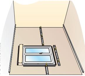
Réaliser l'encadrement de la fenêtre en intégrant le volet roulant avec des lisses Clip Optima 1.
