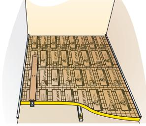
Embrocher l'isolant sur les appuis et les points de fixations puis fixer une lisse bois horizontale 2. Mettre en place les fourrures Optima verticales, devant la lisse bois 3. Visser des tasseaux bois entre les fourrures sur la première lisse 4.
