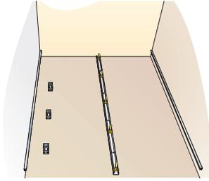
Réaliser l'ossature, lisses Clip'Optima basses et hautes, fourrure horizontale Optima, avec des appuis tous les 60 cm. En hauteur, après avoir précisément tracé les emplacements, fixer des cornières et contre cornières métalliques qui faciliteront le réglage au point d'accrochage des éléments de cuisine 1.
