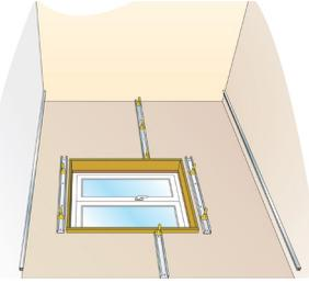
Pour mettre en œuvre le système Optima avec une fenêtre en tunnel 1, commencer par poser des tasseaux bois sur le pourtour des 4 tableaux 2.
