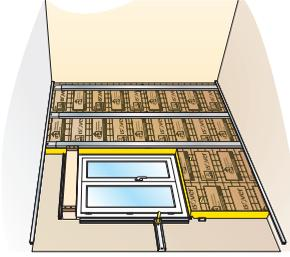
Placer les fourrures verticales de l'arête des tableaux droit et gauche, faisant la jonction lisses basses / hautes : bien régler leur verticalité et leur écartement. Mettre en place des traverses en lisse Clip Optima sous la fenêtre et au-dessus du coffre de volet, calées sur les fourrures verticales 3.
