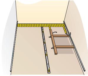
Isoler les tuyaux de plomberie avec de la laine à enrouler, type Isolair. Créer une ossature bois fixée au mur et prenant appui au sol, à l'emplacement des futurs points de fixation du radiateur 1.
