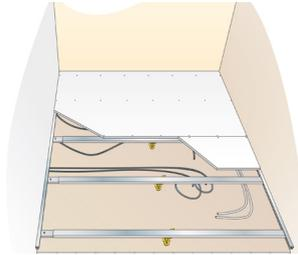
Clipser des fourrures Optima sur les appuis Optima 2 **5**.
