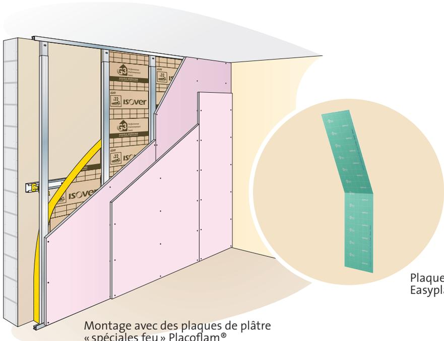
Montage avec des plaques de plâtre « spéciales feu » Placoflam®
