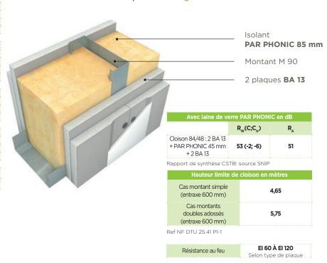
Pour les cloisons à double ossature, grâce au découplage entre les parements et grâce à la double épaisseur décalée de laine de verre PAR PHONIC PRO, le gain d'affaiblissement obtenu peut aller jusqu'à 15 dB.
