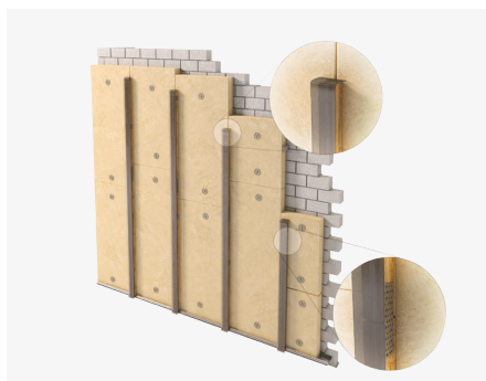
C Fixation des ossatures et pose des bandes de protection sur chevrons
