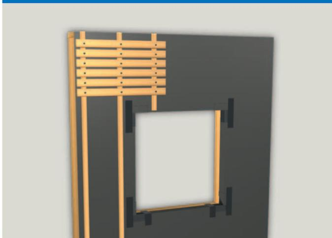
**A l'intérieur :** pour l'étanchéité à l'air
