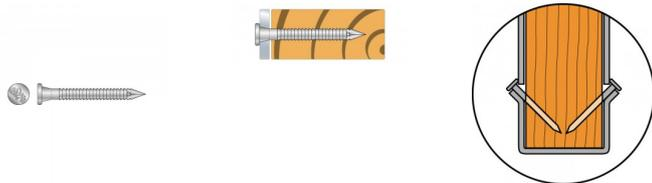
Les pointes annelées électrozinguées CNA sont préconisées pour les assemblages structurels des connecteurs Simpson Strong-Tie. Tous nos essais ont été réalisés avec ce type de pointes. Pour plus de traçabilité sur les chantiers, elles sont estampillées ≠, une garantie de qualité sans équivalent.
